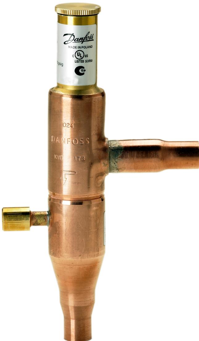
Der KVD ist ein modulierender Sammlerdruckregler. Er öffnet bei abfallendem Druck im Sammler und leitet Heißgas über einen Bypass zur Aufrechterhaltung des am Regler eingestellten (verstellbaren) Druckes im Sammler.
