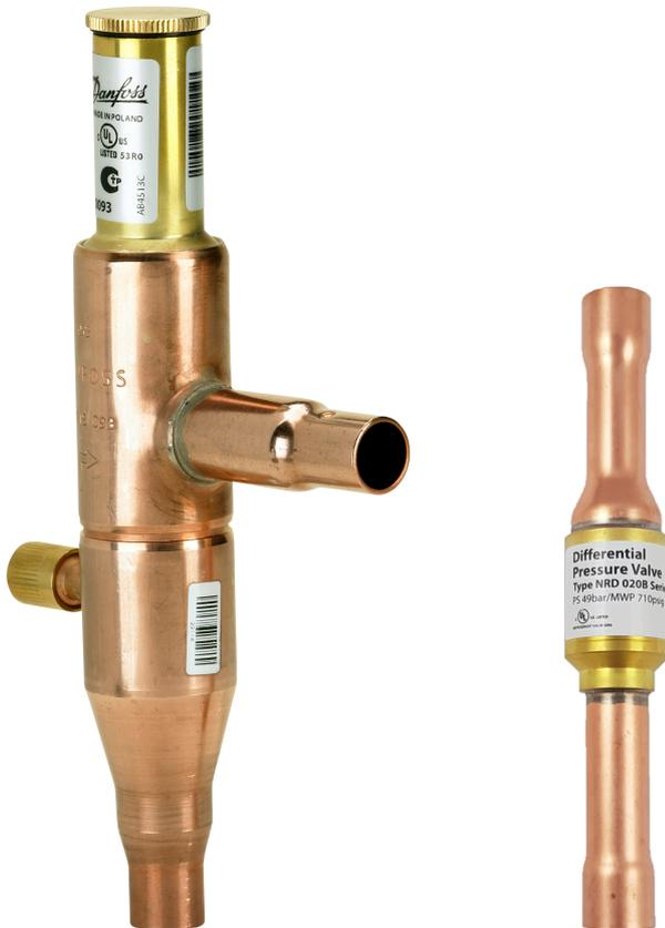
Das Regelsystem aus KVR und NRD dient der Aufrechterhaltung eines konstanten und ausreichend hohen Verflüssigungs- und Sammlerdrucks in Kälte- und Klimaanlage mit luftgekühlten Verflüssigern.
