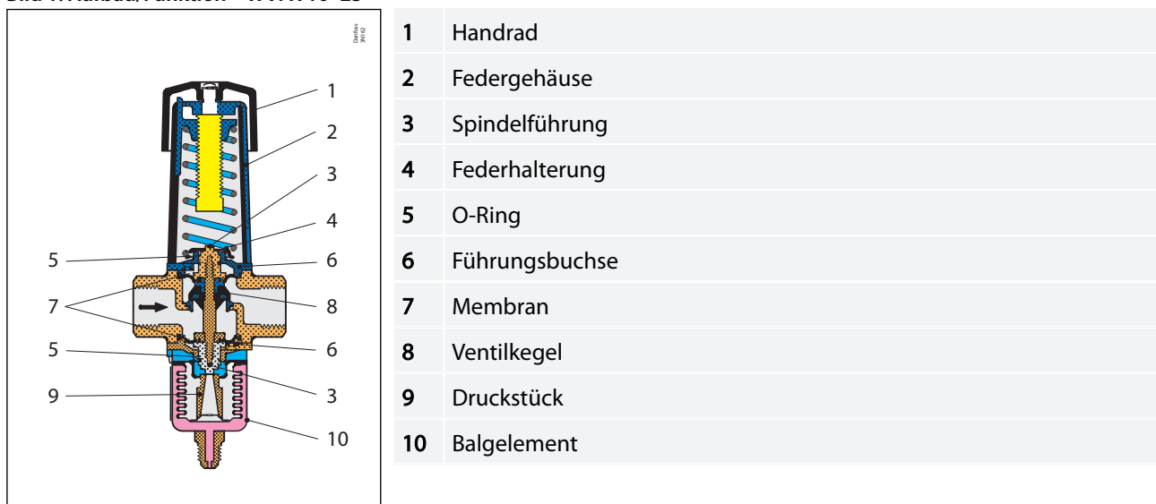
Bild 1: Aufbau/Funktion – WVFX 10–25
