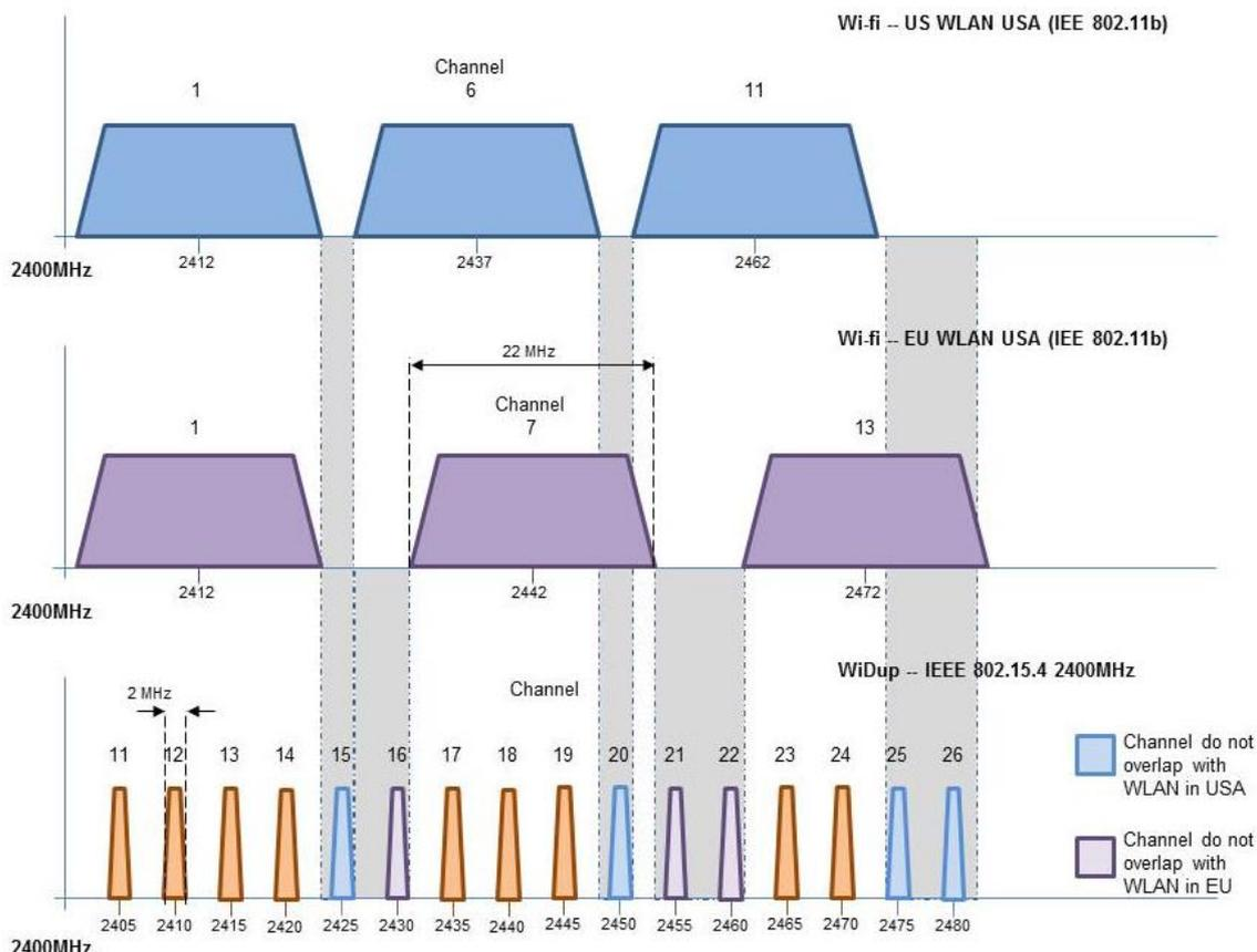
Poiché il canale 15 di WiDup non si sovrappone alle bande Wi-Fi né negli Stati Uniti né in Europa, questo canale viene usato dal sistema smart-house per cercare i moduli slave wireless presenti sul campo. Per quanto concerne la banda operativa, a seconda del canale Wi-Fi impostato dal router, si raccomanda di selezionare un canale WiDup non-sovrapposto: ad esempio, se il router funziona sul canale 1, per il funzionamento di SH2WBU230 si possono selezionare i canali da 15 a 26.
