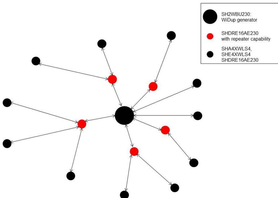
Nella progettazione della rete, è necessario fare attenzione ad assegnare correttamente i moduli slave al relativo router al fine di renderli visibili a SH2WBU230.
