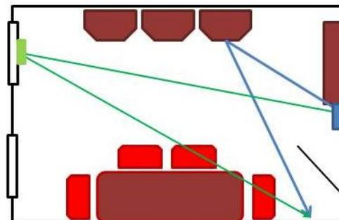
Porre attenzione ai pannelli in metallo, alle finestre in vetro metallizzato o agli specchi, che riflettono la maggior parte della potenza incidente, ostacolando il passaggio del segnale. Vi sono tuttavia alcune onde radio che si possono propagare attraverso fessure molto piccole.
