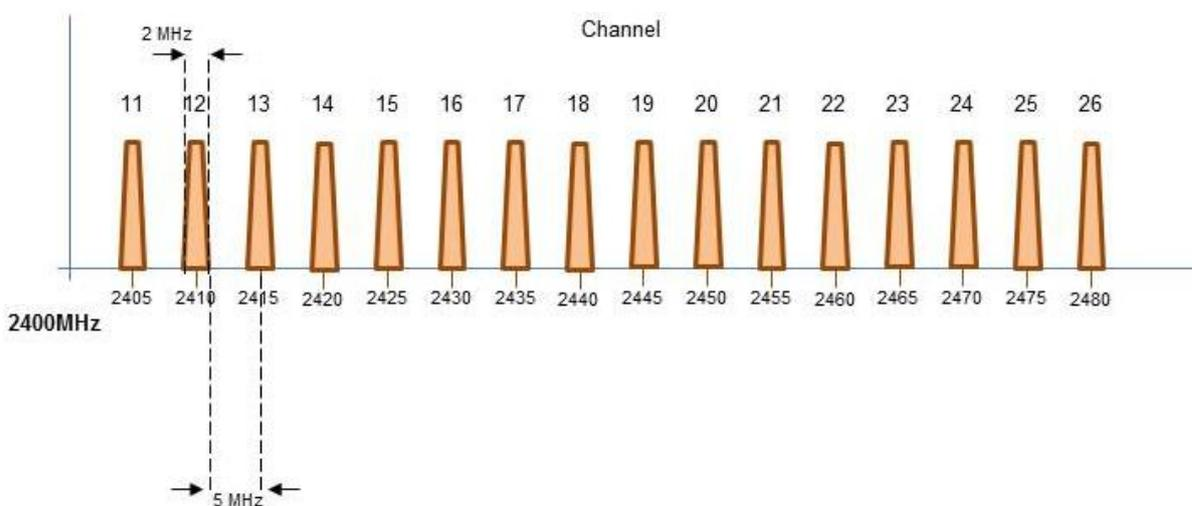
WiDup usa il canale N. 15 per scansionare la rete wireless e identificare i moduli slave ed è fisso, mentre i canali che funzionano possono essere impostati da 11 a 26 conformemente alla presenza di altri sistemi che funzionano a 2.4GHz. La selezione deve essere effettuata tramite il software SH-tool.
