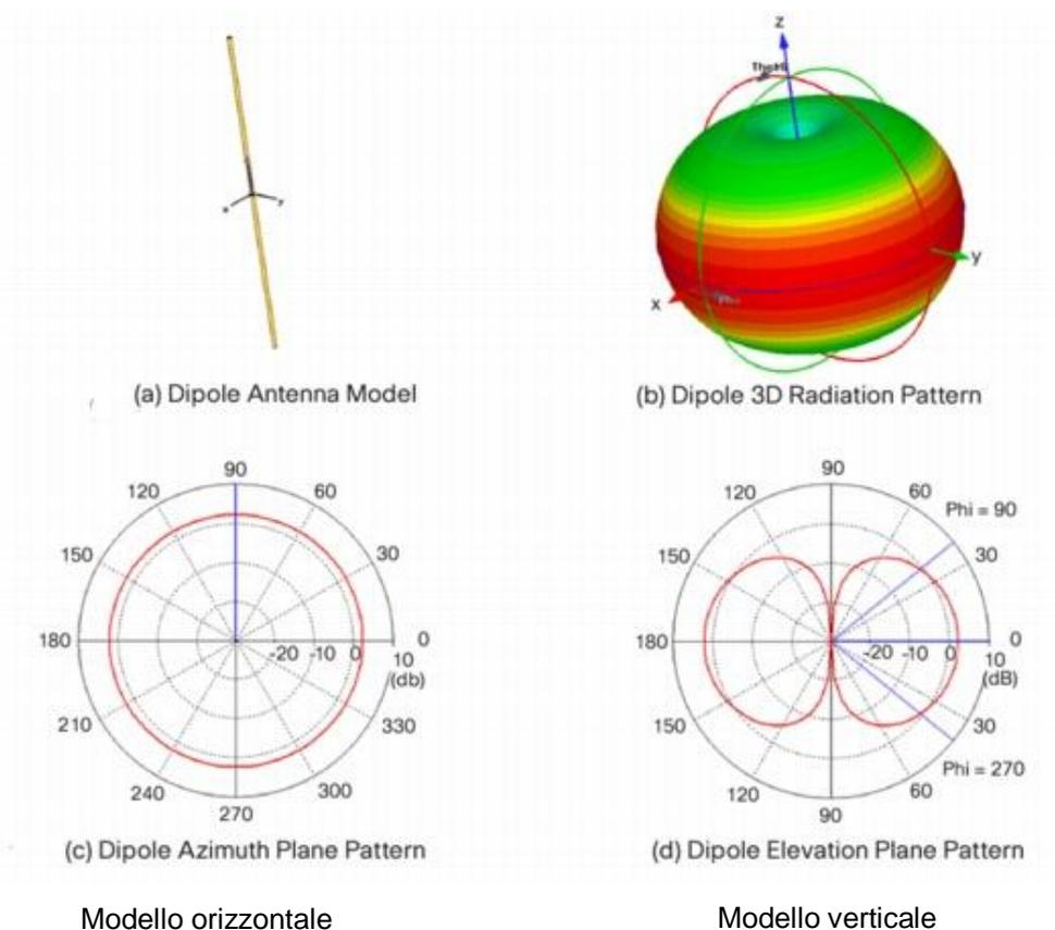
Nel progettare una rete wireless WiDup, dovrebbe essere preso in considerazione questo modello di emissione, al fine di assicurare che SH2WBU230, SHA4XWLS4, SHE5XWLS4 e SHDWRE16AE230, montati in una data posizione, abbiano la copertura sia su un asse verticale che su un asse orizzontale.
