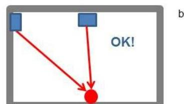
In installazioni a più piani, si suggerisce di installare un'unità base wireless SH2WBU230 su ciascun piano al fine di avere la miglior copertura radio possibile e di evitare un'attenuazione del segnale dovuta a solai o pavimenti in calcestruzzo armato.
