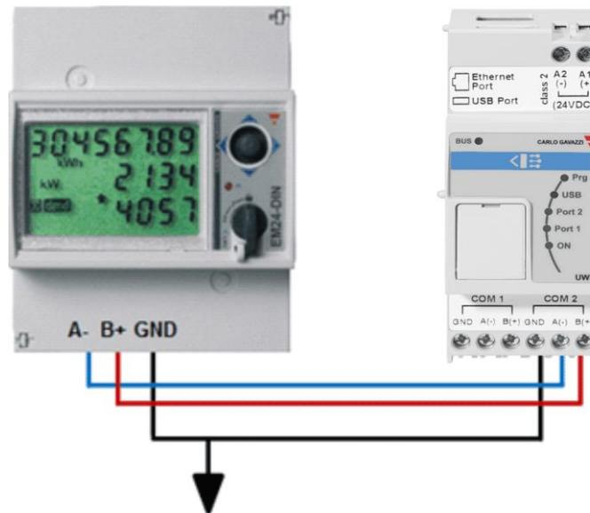
Pueden mezclarse diferentes tipos de medidores de energía que, por su parte, pueden tener una velocidad de baudios diferente (véase el manual de software de la herramienta SH para obtener más detalles sobre cómo configurar el UWP 3.0 para gestionarlos).
