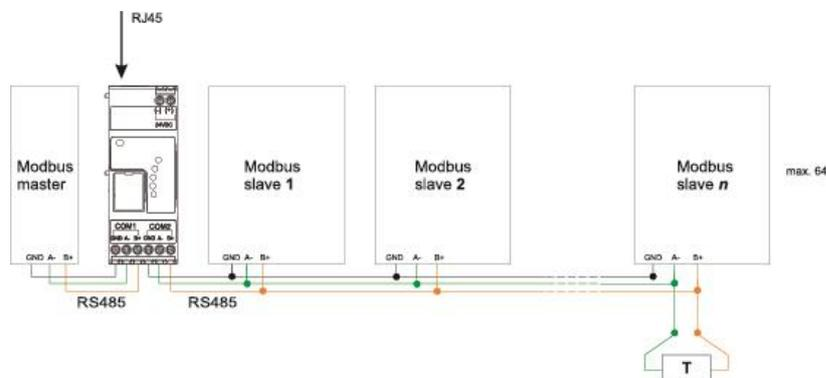
*Conexión Modbus RTU. Esclavo COM 1, esclavo COM 2*
