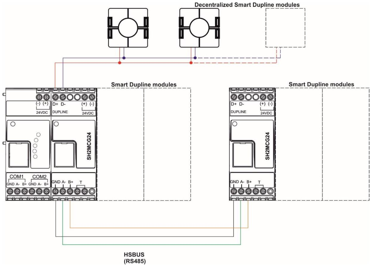
*Ejemplo de conexión de módulos Smart Dupline con generadores de canal maestros*
