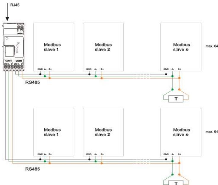
*Conexión Modbus RTU. Maestro COM 1, maestro COM 2*
