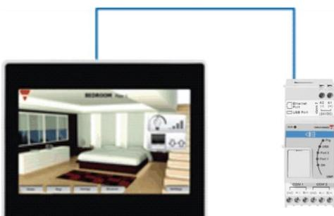
El dispositivo TCP/IP puede conectarse directamente al UWP 3.0 con una conexión punto a punto utilizando una IP fija (véase el manual de la herramienta SH para configurar una IP fija).
