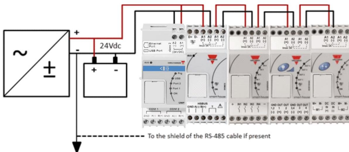
Todos los módulos montados en carril DIN con los terminales de entrada y salida disponen de dos cables cortos atornillados a los terminales A1 y A2 con el fin de acelerar la puesta en marcha.
