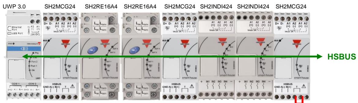
Tampoco en este caso es necesario cablear el RS485 para el bus de alta velocidad puesto que el conector del bus local de los módulos Dupline® es transparente. El instalador únicamente debe terminar el bus de alta velocidad en el último generador de bus de la red RS485.
