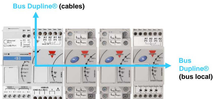
Si hubiera más generadores de bus conectados a un carril DIN, no necesitan conectarse juntos y pueden mezclarse con los módulos E/S Dupline®. La única norma que el instalador debe tener en cuenta es que un módulo E/S Dupline® esté conectado a la red Dupline® creada por el último SH2MCG24 a su izquierda. Véase la imagen inferior.
