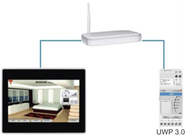
El dispositivo TCP/IP puede conectarse al UWP 3.0 mediante un rúter utilizando tanto el direccionamiento DHCP como una IP fija con reenvío NAT si el UWP 3.0 debe visualizarse a través de internet.
