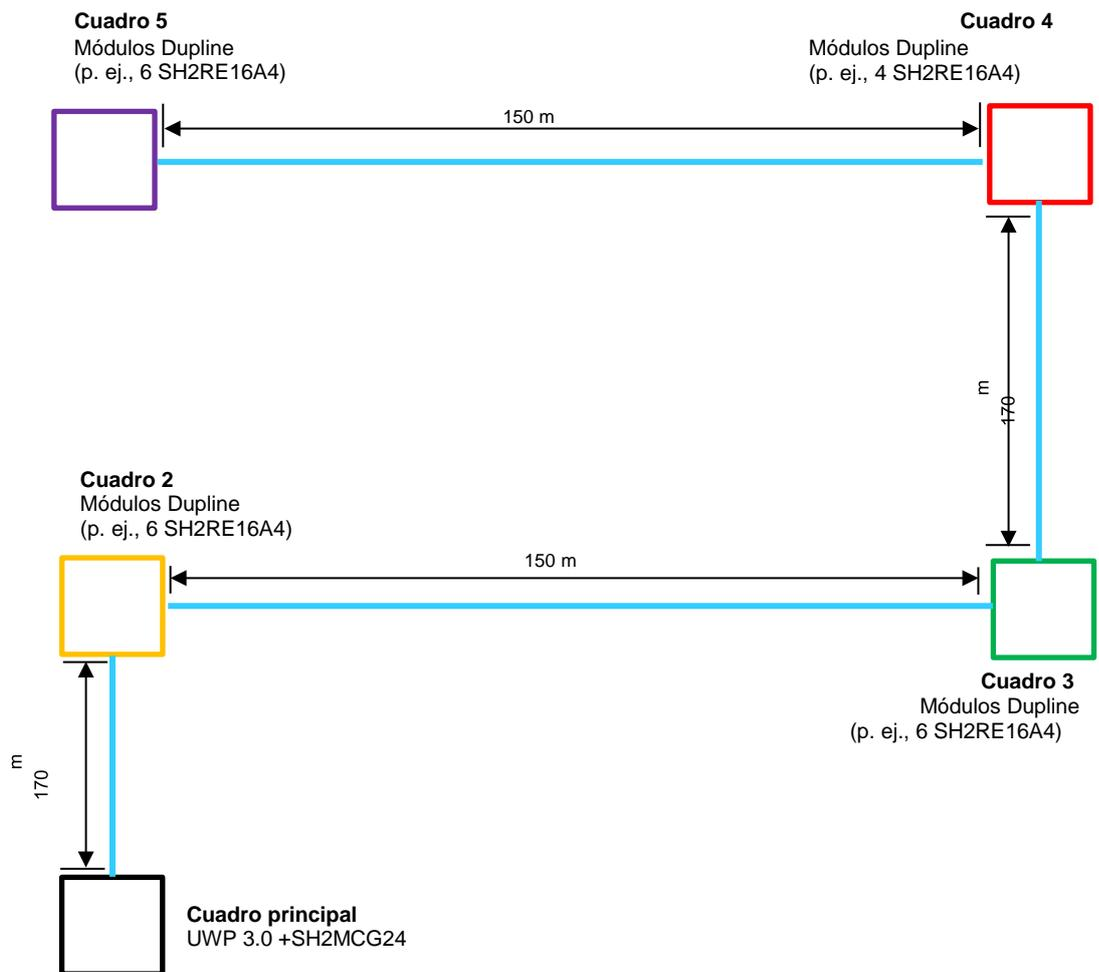
No se recomienda este diseño de red, ya que la resistencia del cable y la carga de los módulos con bus de alimentación dan lugar a una caída excesiva de la presión.
