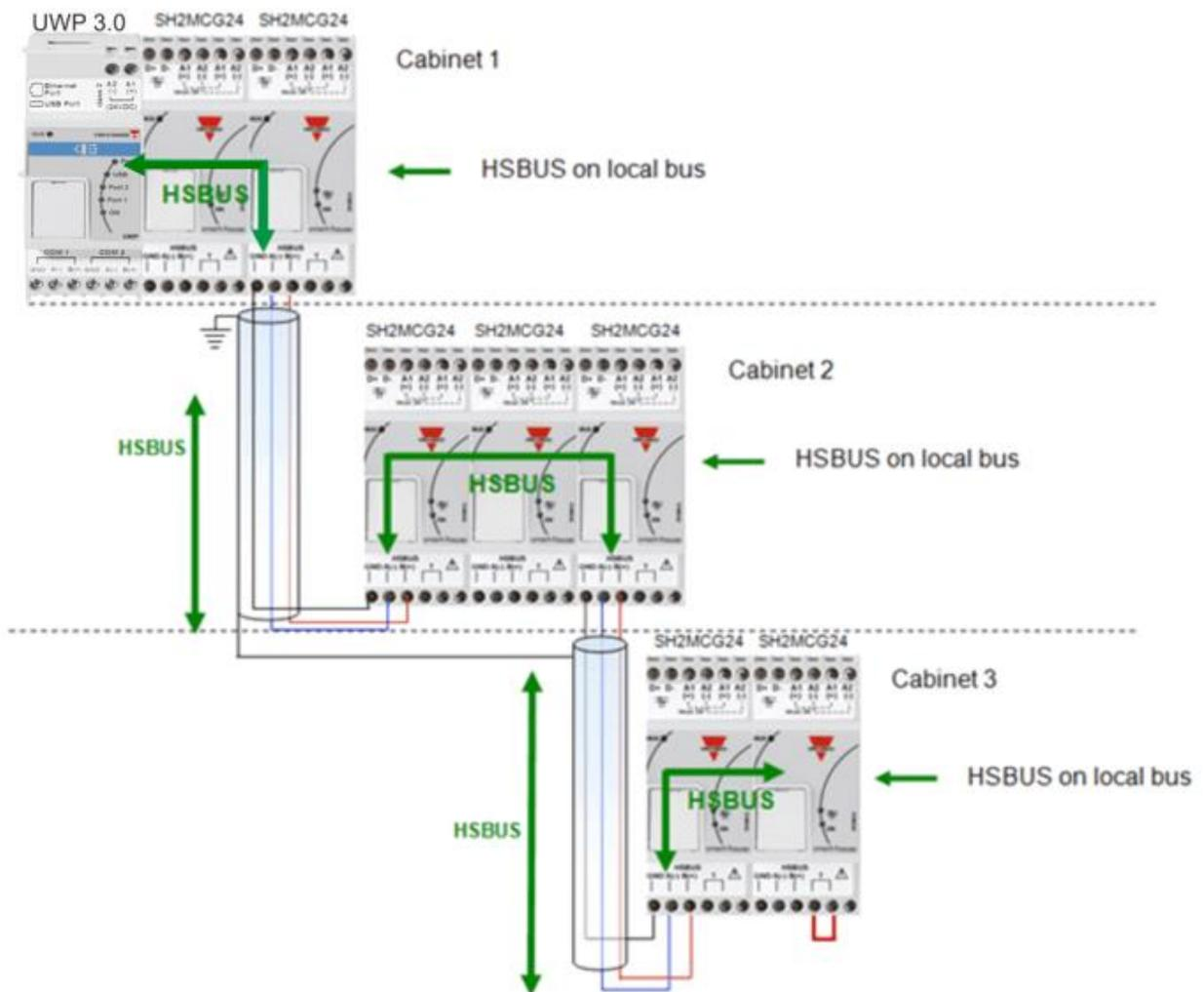
**Ejemplo 3:** Los generadores de bus SH2MCG24 no necesitan colocarse todos juntos en un carril DIN, y pueden mezclarse con los módulos Dupline® tal y como se muestra en la figura inferior.
