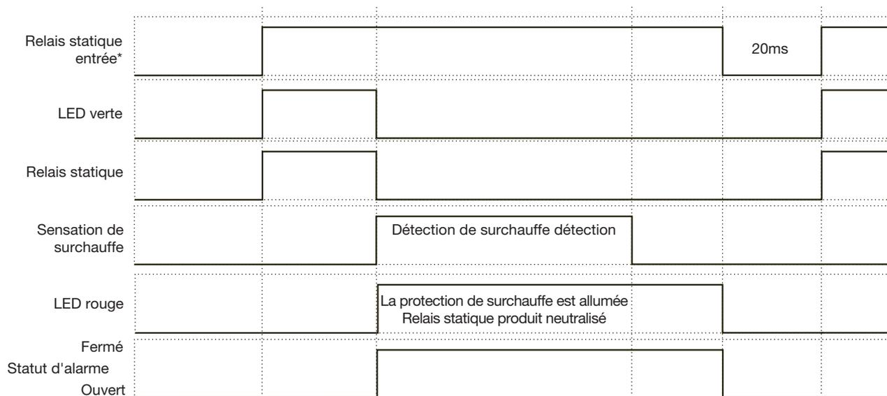
\*Après suppression de la condition de surchauffe, on peut réinitialiser le relais statique en commutant sur OFF l'entrée de commande pendant plus de 20 ms puis en commutant de nouveau sur ON: cette commutation a pour effet d'activer la sortie relais
