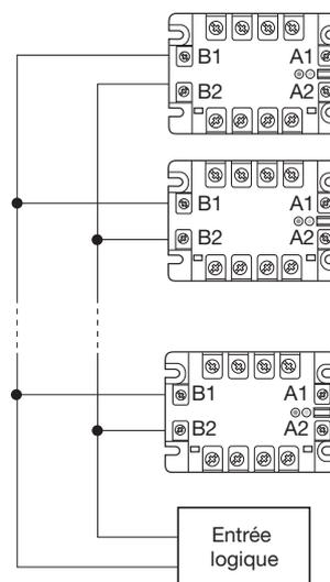
Fig. 2 Raccordement de la sortie alarme
