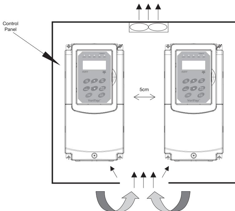
Il est nécessaire de prévoir un espace physique et un refroidissement suffisants, en fonction de la température ambiante et de la perte de chaleur dans le tableau.
