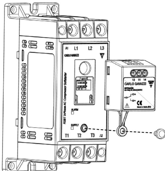
Le RFPM est un module auxiliaire branchable à relais et est fourni en tant qu'accessoire. Pour installer le RFPM, prière de procéder comme suit :
