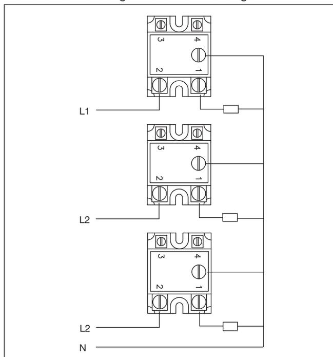
Drehstromanwendung mit einer Heizwicklungen.
