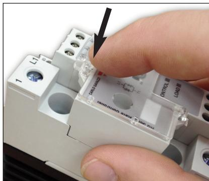
2. Fermer le capot en le clipsant à l'accroche situé en haut de la face avant du RGx1P
