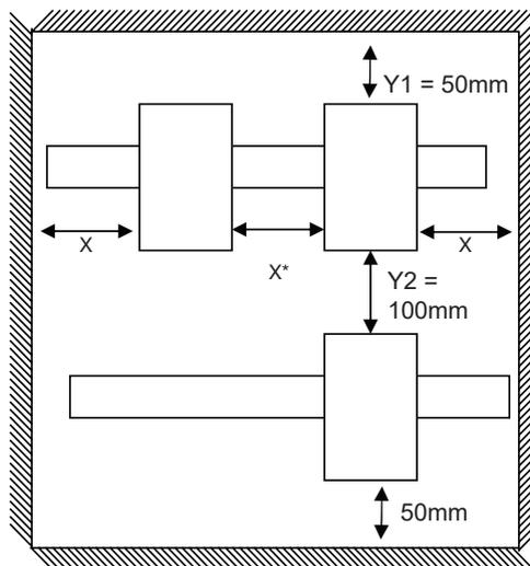
\* Voir Courbes de déclassement du courant pour les espacements à 0 mm pour des espacements de 0 mm entre les relais. L'espacement entre les relais statiques et les parois murales doit être supérieur à 5 mm.
