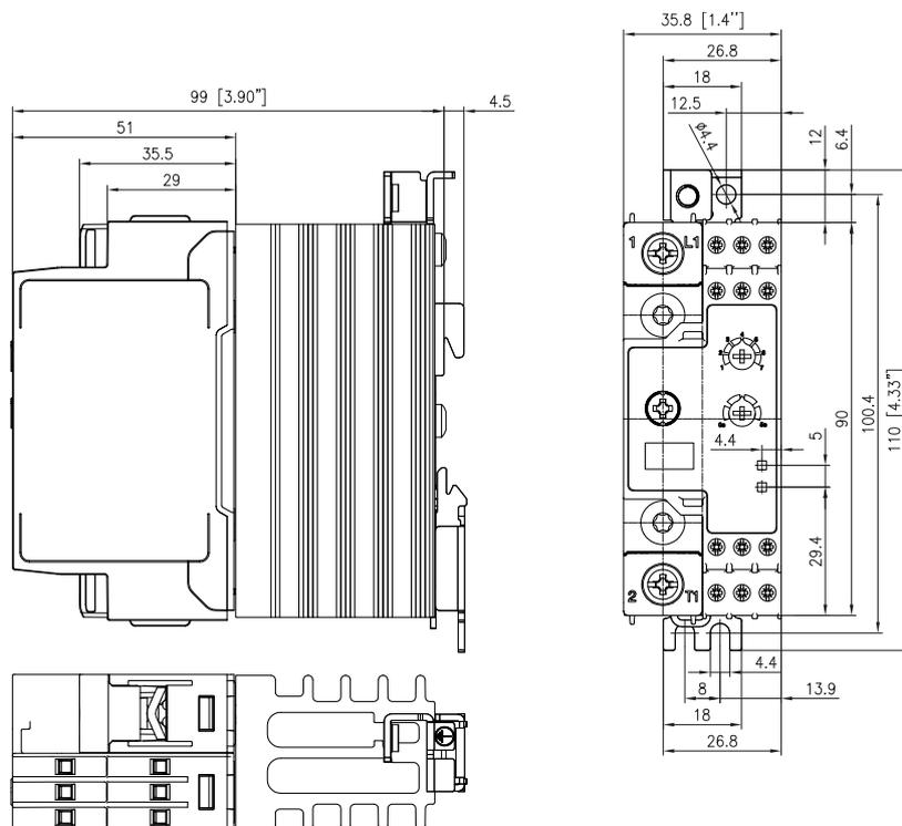
La tolérance de la largeur du logement doit être de +0.5 mm, -0 mm conformément à la norme DIN43880. Toutes autres tolérances: +/-0,5 mm. Toutes les dimensions en mm.
