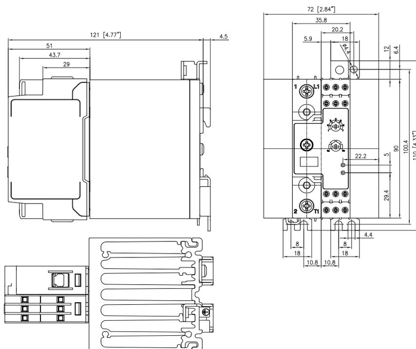
La tolérance de la largeur du logement doit être de +0.5 mm, -0 mm conformément à la norme DIN43880. Toutes autres tolérances: +/-0,5 mm. Toutes les dimensions en mm.
