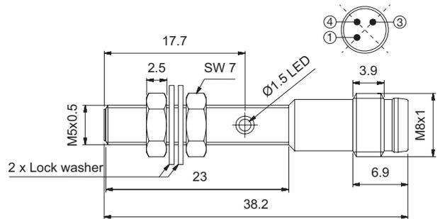
Abb. 14 Kurze Ausführung, Nicht bündiger Einbau, Kabel
