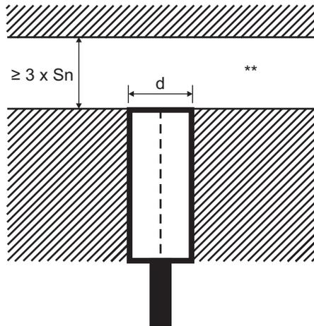
**Abb. 15** Bündige Sensoren eingebaut in dämpfendem Material
