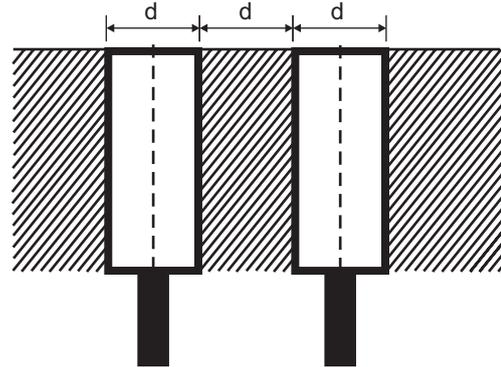
**Abb. 16** Mehrere bündige Sensoren eingebaut in dämpfendem Material
