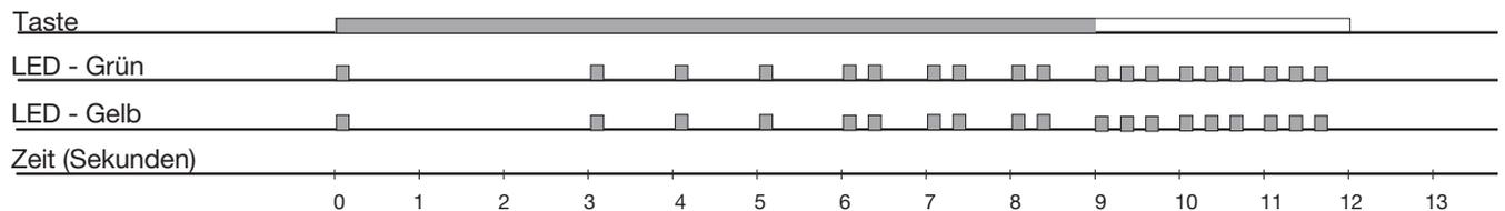
Wird die Taste nach 12 Sekunden losgelassen, kehrt der Sensor zu den werksseitigen Einstellungen zurück
