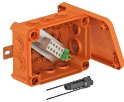
Alogeno-libero della scatola di giunzione pre-montato, soft plug-in di guarnizioni, approvato per la funzione elettrica di manutenzione secondo la norma DIN 4102, Parte 12. Funzione di classi di mantenimento E30 per E90.
