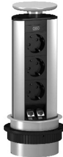
Abbattibili, Deskbox con cavo di collegamento per installazione fissa su un tavolo, in plastica di fissaggio manicotto, dipinto di conseguenza la copertura di un ombra. Esso è montato utilizzando un trapano per praticare un foro ( $\varnothing 102$  mm) nel tavolo.
