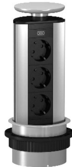
Abbattibili, Deskbox con cavo di collegamento per installazione fissa su un tavolo, in plastica di fissaggio manicotto, dipinto di conseguenza la copertura di un ombra. Esso è montato utilizzando un trapano per praticare un foro ( $\varnothing 102$  mm) nel tavolo.
