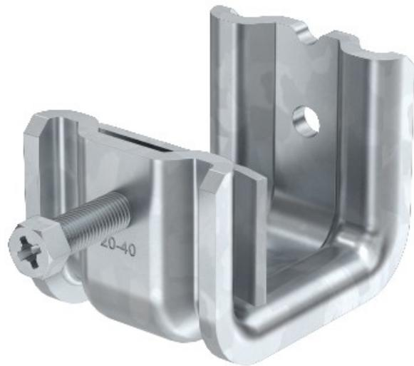
Questo tipo di morsetto del fascio viene inserito il supporto e fissato alla trave o ferro piatto utilizzando una pressione di minimo e la vite (M8). La vite a testa esagonale ha un WAF di 10 mm. Nella clip, elemento, due ulteriori M6 thread sono anche incorporati, per fissare le barre filettate, per esempio.
