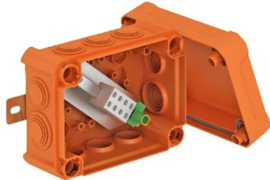
Halogen-free scatola di giunzione con impatto a prova di copertura e pre-montato, soft plug-in di guarnizioni, approvato per la funzione elettrica di manutenzione secondo la norma DIN 4102, Parte 12. Funzione di classi di mantenimento E30 per E90.
