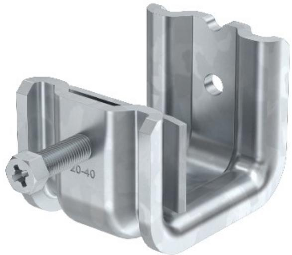
Questo tipo di morsetto del fascio viene inserito il supporto e fissato alla trave o ferro piatto utilizzando una pressione di minimo e la vite (M8). La vite a testa esagonale ha un WAF di 10 mm. Nella clip, elemento, due ulteriori M6 thread sono anche incorporati, per fissare le barre filettate, per esempio.
