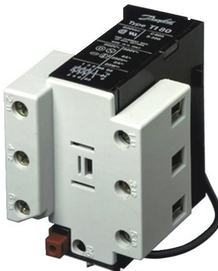
Il relè termici TI 80-86 coprono la gamma da 16-85 Amp e proteggere i motori a gabbia di scoiattolo fino a 45 kW, contro il sovraccarico. Per l'uso con i contattori CI da 32 a IC 86 design Compatto Stop/reset tasto reset Manuale/automatico la funzione di Prova di funzione di allarme DOL scala / Y-Δ scala a contatto di Commutazione Singola protezione di guasto di fase
