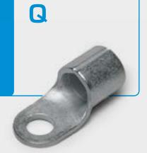
I capicorda della serie Q sono ricavati da piattina di rame elettrolitico, ricotti e protetti superficialmente mediante stagnatura elettrolitica; le dimensioni sono conformi alla norma DIN 46234; il colletto è brasato con una lega Rame-Argento.
