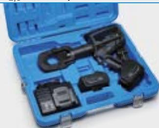
Utensile oleodinamico portatile a batteria di nuova generazione, caratterizzato da funzionalità ulteriormente migliorate. Equipaggiato con batterie Li-Ion 18 V 4 Ah che offrono una maggiore capacità delle precedenti 14,4 V 3 Ah. Adatto ad effettuare il taglio di cavi in rame e in alluminio.
