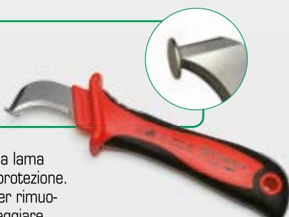
Coltello isolato per cavi, a lama curva con cappuccio di protezione. È munito di guidalama per rimuovere guaine senza danneggiare isolanti o schermi. Impugnatura in materiale plastico bicomponente.
