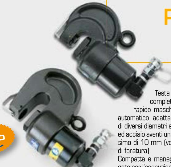
Testa oleodinamica completa di innesto rapido maschio a bloccaggio automatico, adatta ad eseguire fori di diversi diametri su barre di rame ed acciaio aventi uno spessore massimo di 10 mm (vedi tab. capacità di foratura).
