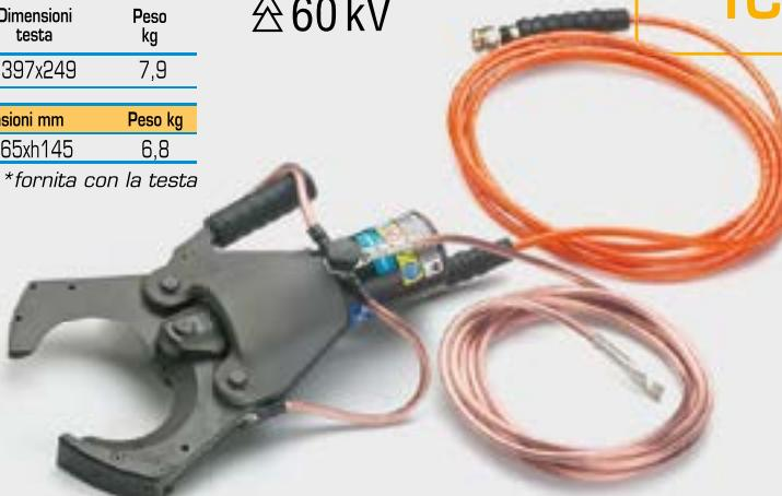
Testa idonea all'esplorazione di cavi B.T./M.T. incidentalmente in tensione ed al taglio successivo (tensione di esercizio del cavo Max 60 kV) completa di tubo flessibile ad alto potere dielettrico della lunghezza di 5 m, direttamente collegato alla testa da un lato e munito di innesto rapido maschio a bloccaggio automatico tipo I38-MS dall'altro per il collegamento alla pompa predisposta per unità isolate.
