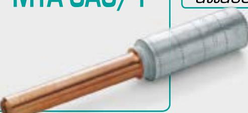
Il capocorda tipo MTA 150-CAC/1 ha il colletto in alluminio con purezza non inferiore a 99,5% e l'attacco a codolo in rame elettrolitico. La giunzione bimetallica, realizzata mediante saldatura a frizione, è opportunamente protetta per l'impiego su linee aeree in conduttori non isolati.
