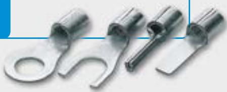
I capicorda della serie S sono ricavati da nastro di rame ETP, con colletto brasato, ricotti e protetti superficialmente mediante stagnatura elettrolitica.
