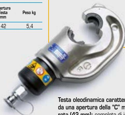
Testa oleodinamica caratterizzata da una apertura della "C" maggiorata (42 mm); completa di innesto rapido maschio con bloccaggio automatico, avente gli stessi campi d'utilizzo dell'utensile HT 131LN-C. Per il suo funzionamento è necessario abbinarla ad una pompa oleodinamica (vedere pag. 182-186).
