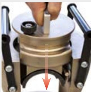
Dopo la sostituzione della matrice inserire il supporto matrice nella testa.
