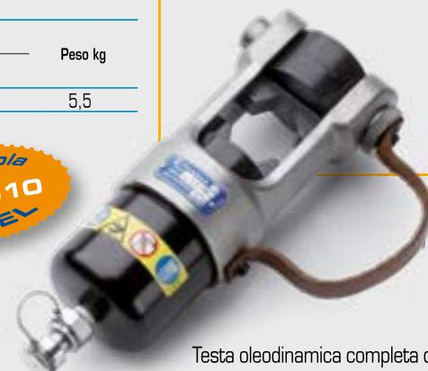
Testa oleodinamica completa di innesto rapido maschio con bloccaggio automatico. Può impiegare, mediante l'adattatore tipo AU 230-130 D, la serie di matrici ad innesto semicircolare comune agli utensili sviluppati una forza di 130 kN.
