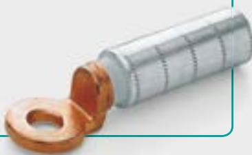
Il capocorda tipo CAA 150 AC ha il colletto in alluminio con purezza non inferiore a 99,5% e la patella di attacco in rame elettrolitico. La giunzione bimetallica, realizzata mediante saldatura a frizione, è opportunamente protetta per l'impiego su linee aeree in conduttori non isolati.
