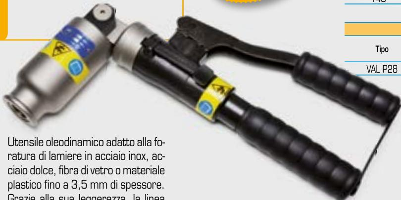
Utensile oleodinamico adatto alla foratura di lamiere in acciaio inox, acciaio dolce, fibra di vetro o materiale plastico fino a 3,5 mm di spessore. Grazie alla sua leggerezza, la linea compatta ed alla testa girevole di 360° e ruotabile di 180°, risulta estremamente versatile e maneggevole. Fornito completo di Tiranti TD-11, TD-19 e punta elicoidale Ø 11,5 mm. Per informazioni sugli accessori di foratura disponibili consultare la pag. 159.
