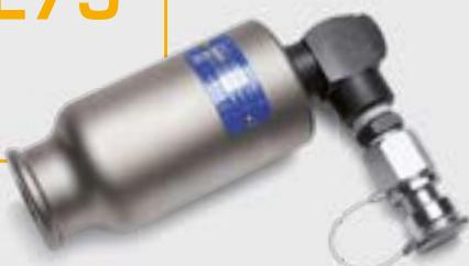
Testa oleodinamica adatta alla foratura di lamiere in acciaio inox, acciaio dolce, fibra di vetro o materiale plastico fino a 3,5 mm di spessore. Grazie alla sua leggerezza ed alla linea compatta è facilmente manovrabile dall'operatore anche in spazi ristretti. Completa di innesto rapido maschio con bloccaggio automatico, Tiranti TD-11, TD-19 e punta
