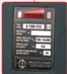
Visualizzazione dello stato di carica della batteria
