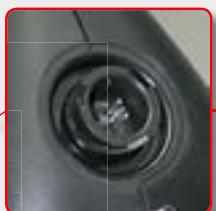
Attacco per pulsantiera di comando pneumatica (solo per versione KV)
