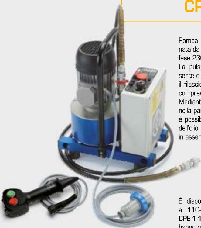
Pompa elettro-oleodinamica azionata da un motore elettrico monofase 230 V / 50-60 Hz. La pulsantiera di comando consente oltre all'avanzamento anche il rilascio della pressione dell'olio a compressione ultimata.
