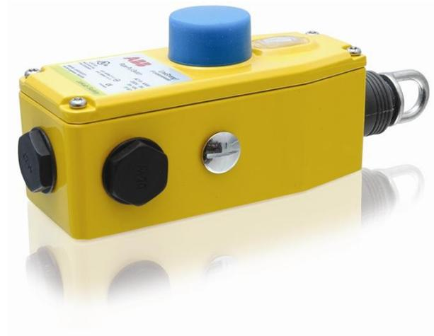
Arresto di emergenza afferrare il filo interruttore di sicurezza 2NC + 2NA, Fino a 50m di lunghezza, die cast abitative, entrata cavi 3xM20
