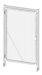
Quick-Guard E sezione di porta con 44x44/44x88mm profili. Compresi i componenti profili, rete elettrosaldata, policarbonato, staffe da pavimento e netlocks. Totale altezza 2000 mm, larghezza 1100 mm c-c profili.
