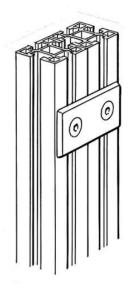
I - a forma di staffa di montaggio in Alluminio per il montaggio di profili insieme. Dimensione 41x85x6mm, pre-assemblato.
