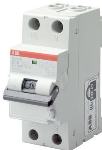
Il DS201 serie RCBO è un 1P+N in due moduli dispositivo per la protezione dell'utente finale monofase circuiti contro i sovraccarichi e i cortocircuiti; fornisce un ottimale compromesso tra la sicurezza e la continuità del servizio, grazie alla resistenza all'indesiderato trippings; protezione contro i contatti indiretti e protezione addizionale contro i contatti diretti (sensibilità = 30 mA); la protezione e l'isolamento di carichi induttivi e resistivi.
