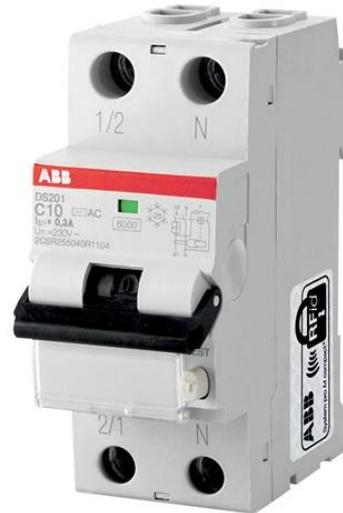
Il DS201 serie RCBO è un 1P+N in due moduli dispositivo per la protezione dell'utente finale monofase circuiti contro i sovraccarichi e i cortocircuiti; protezione contro gli effetti dell sinusoidale alternata e continua pulsante terra le correnti di guasto; protezione contro i contatti indiretti e protezione addizionale contro i contatti diretti (sensibilità = 30 mA).
