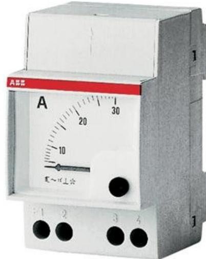
AMT 1/15 è un amperometro analogico, usato nelle reti ac. Inserzione diretta fino a 15 A.
