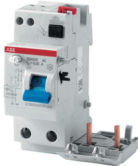
Il RCD blocco DDA200 serie è adatto per il montaggio con MCBs S200 serie. Assicura la protezione contro gli effetti dell' sinusoidale alternata correnti di guasto a terra, la protezione contro indirects contatti e una protezione aggiuntiva contro le dirette (sensibilità = 30 mA) contatti. Applicazioni: residenziale, commerciale, industriale.
