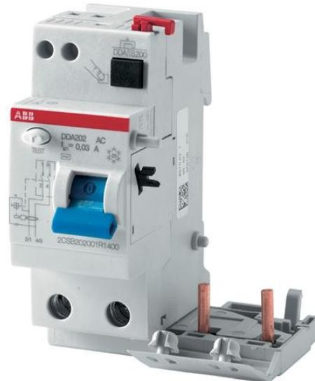
Il RCD blocco DDA200 serie è adatto per il montaggio con MCBs S200 serie. Assicura la protezione contro gli effetti dell' sinusoidale alternata e continua pulsante terra le correnti di guasto, fornire il miglior compromesso tra sicurezza e la continuità del servizio grazie alla resistenza alle indesiderati trippings. Protezione contro i contatti indiretti e una protezione aggiuntiva contro le dirette (sensibilità = 30 mA) contatti. Applicazioni: residenziale, commerciale, industriale.
