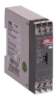
Il CT-AHE è una singola funzione elettronici relè di tempo il CT-E timer di intervallo. Esso fornisce un OFF-delay (ritardo di pausa) funzione con un intervallo di tempo da 0,3 s 30 s. Questo relè a tempo opera con una potenza di controllo tensione di alimentazione di 24 V AC / DC e ha un 1 c/o (SPDT) uscita nominale 250 V / 4 A. Un ingresso di controllo funziona con la tensione (non mobile) di attivazione.
