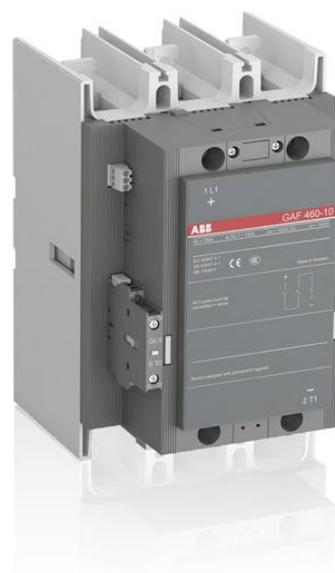
A 3 poli Contattore adatto per DC-1 applicazioni in cui tutti e tre i poli devono essere collegati in serie in un 1-polo di configurazione fino a max 1000 VDC. Gestito con ampia gamma di tensione di controllo 100-250 V, AC/DC
