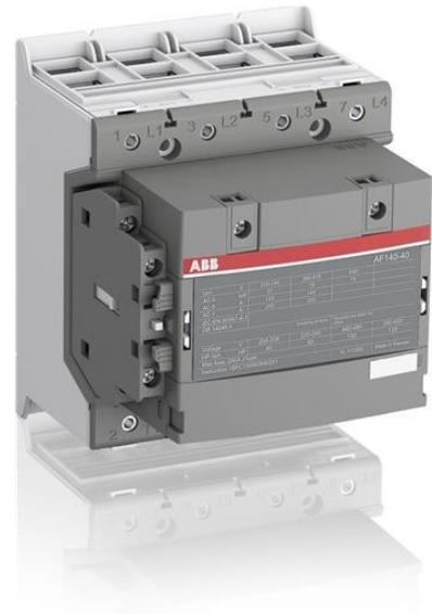
3-fase di Contattore adatto per varie applicazioni come Motore di avviamento, di Isolamento, di By-pass e la Distribuzione di applicazioni fino a max 690 V. Operato con ampia gamma di tensione di controllo 250-500 V, 50/60 Hz DC
