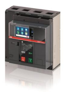
C. INTERRUTTORE SACE EMAX2 E1.2C 1000 FISSA a QUATTRO POLI CON parte ANTERIORE TERMINALI E a STATO SOLIDO RILASCIO di AC EKIP/G/HI-TOUCH-LSIG R 1000 DOTATO di: 4 CONTATTI AUSILIARI E C. INTERRUTTORE IN POSIZIONE di APERTO-CHIUSO
