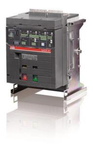
PARTE IN MOVIMENTO PER INTERRUTTORE EMAX X1L 1000 a TRE POLI CON STATO SOLIDO RILASCIO di AC PR331/P-LSI R 1000 DOTATO di: 4 CONTATTI AUSILIARI E C. INTERRUTTORE IN POSIZIONE di APERTO-CHIUSO
