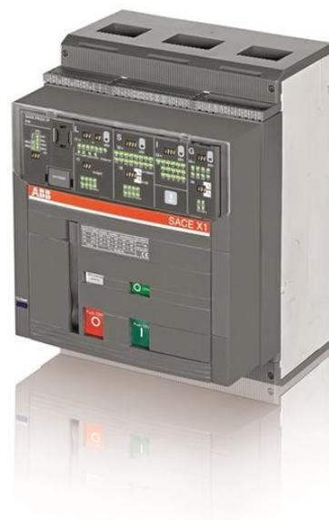
C. INTERRUTTORE EMAX X1L 800 FISSO a TRE POLI CON parte ANTERIORE TERMINALI E a STATO SOLIDO RILASCIO di AC PR331/P-LSI R 800 DOTATO di: 4 CONTATTI AUSILIARI E C. INTERRUTTORE IN POSIZIONE di APERTO-CHIUSO
