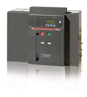
SACE EMAX INTERRUTTORE E4V 4000A THRE-POLO FISSO CON TERMINALI POSTERIORI ORIZZONTALI SOVRACORRENTE RILASCIO PR122/P-LI R4000 DOTATO di: 4 CONTATTI AUSILIARI E C. INTERRUTTORE IN POSIZIONE di APERTO-CHIUSO
