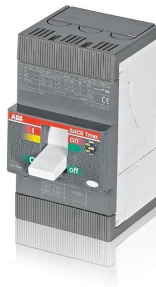
C. INTERRUOTTORE TMAX T1C 160 FISSO a TRE POLI CON parte ANTERIORE TERMINALI PER CAVO Cu 70mm<sup>2</sup> E MAGNETOTERMICO RILASCIO, DA R 80-800 UN
