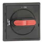
Tipo di selettore, manico. Indicazione I-O e ON-OFF. Non un albero separato necessario. Lucchettabili con max. 3 lucchetti, IP 65, NEMA 1, 3R, 12, colore nero, OT16...40FT
