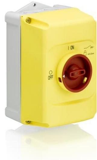
IB132-Y custodia è adatto per manuale motore avviamento MS116/MS132. La combinazione di manuale di avviamento motore e enclosure permette di configurare tutte le richieste di controllo e funzioni di protezione per singola macchina installazioni. La custodia ha un grado di protezione IP65. Di montaggio aggiuntivo di contatti ausiliari e di segnalazione, derivazione viaggi e sganciatore di minima tensione è possibile. Il manico è fino a 3 volte chiudibile a chiave in posizione "OFF".
