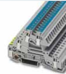
4 (4) mm 2 , 32 A, Dreistockklemme, 1 x Außenleiter L, 1 x N-Leiter, 1 x PE
