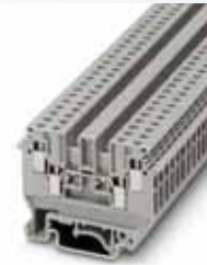
4 (6) mm 2 , 32 A, Durchgangsklemme, 4 Anschlüsse
