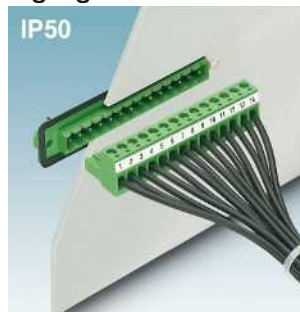
Grundgehäuse zur Wanddurchführung, Raster 5,08 mm, mit Flachsteckanschluss DFK-MSTB(A) 2,5/...-G(F)-... Seite 354
