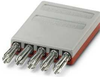
5-poliger Prüfstecker, 5,0/5,08-mm-Raster, kontaktiert im Leiteranschlussraum
