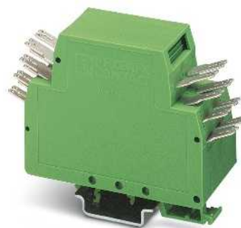
8- und 16-polig mit geschlitztem 6,3/2,8 mm-Flachsteckanschluss, Breite: 30 mm
