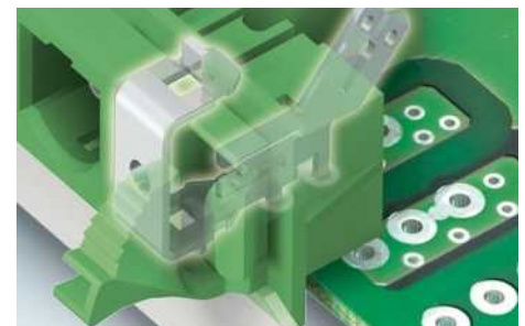
③ Schirmdurchleitung mit der STF-SH-Variante
