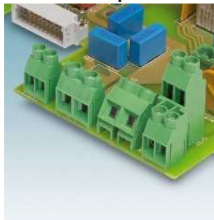
MKDS 5-Serie: Schraubanschluss, bis 32 A Raster 6,35 / 7,62 / 9,52 mm MKDS 5... Seite 443
