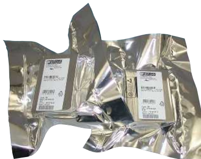
Bauteile im Drybag - MSL 3
