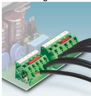
ZFKDS 4-Serie: Zugfederanschluss, bis 32 A, Raster 7,5 / 10 mm ZFKDS 4... Seite 477
