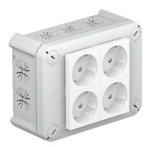
Abzweigkästen sind aus einem thermoplastischen Polypropylen-polymer und sind ausgestattet mit Zugentlastung-Einträge. Diese Einträge können durchdrungen werden direkt mit den Kabeln. Die Besondere Struktur der öffnung bedeutet, dass die Kabel nicht entfernt werden kann, unabsichtlich. Geeignet für Kabel mit Durchmesser von zwischen 7 und 21 mm.
