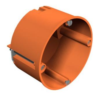
Hohlwand-Zubehör-Steckdose. Maße nach DIN 49073-1, für Plattenstärke 7-35 mm. Standard-Kombination Abstand 71 mm, Möglichkeit zur kontinuierlichen Verdrahtung mit Anschluss-Unterstützung für Kombinationen zwischen Zubehör Steckdosen und Zubehör-Anschlussbuchsen, 8 break-out öffnungen für NYM-Leitungen, Datenleitungen und Rohre Ø 20 mm, Zubehör-Steckdosen können auch verwendet werden, als Verbindung sockets VDE 0606-1 mit Doppel-Bolzen-Befestigung und Schraube-auf dem Deckel, Schutzart IP20.
