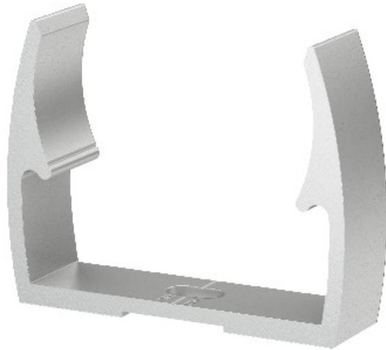
OBO Quick-clip, Typ ALQ M, für alle metrischen ALU-Rohrsysteme sowie leichte und schwere Isolierung von Rohren. Geeignet zur Aufnahme des OBO Rohrsystems, material: aluminium. Rohrzentrierung aids ermöglichen eine optimale Befestigung der Rohr-automatisch drehen Sie den clip in die richtige position. Slot für den seitlichen ausrichten bei Montage mit Holzschraube oder knock-in-Anker. Empfohlen, die Befestigung Abstand von 50-60 cm.
