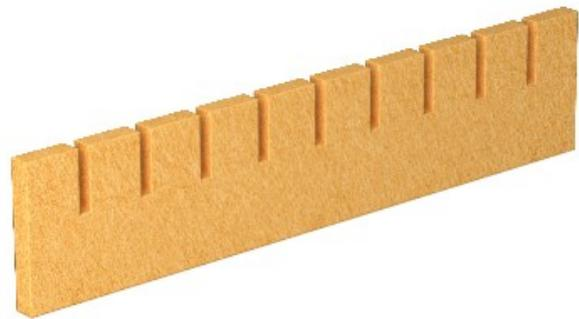
Expanding-Schaum-Module zu ersetzen, die ein Gehäuse in der Dichtmasse-system, wenn ein Teil der Gehäuse verloren gegangen ist. Die Module erweitern Sie um den Faktor 10, wenn bestreut mit der Flüssigkeit tränken, das schließen von Lücken und Fugen zwischen den Kabeln installiert.
