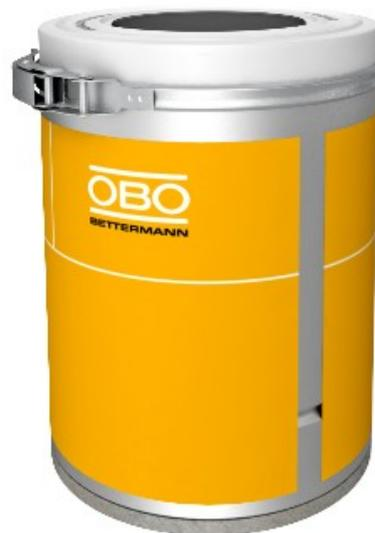
Elektrisch leitfähige Dichtmasse für Isolierungen in Dichtmasse Systemen und für die integration des gewebten Kabel-Abschirmung in EMV-konforme Installationen. 2-Komponenten (härter und Harz) in zinn mit Deckel zu stoßen . Lebensdauer von 6 Monaten bei Lagerung im frostfreien Lagerung.
