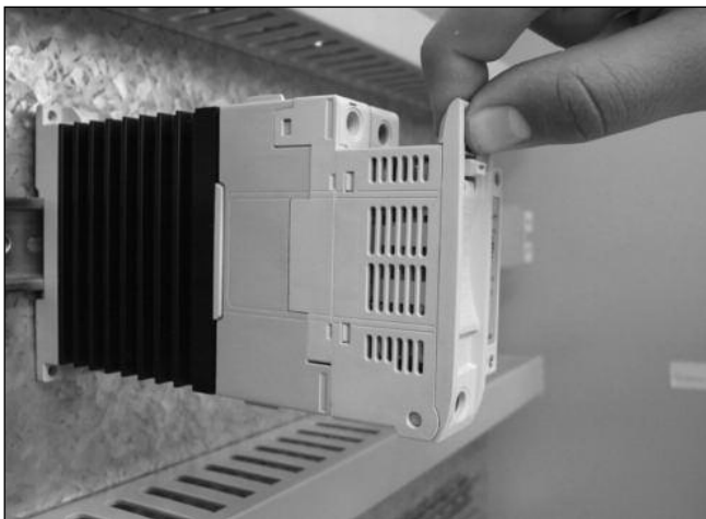
1. Vorbereiten zum Öffnen der Sicherungshalterung.
